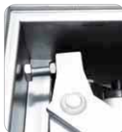
Mechanický doraz uvnitř ochranného krytu
