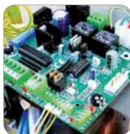
Hlavní elektronická řídicí jednotka (master) ELPRO 35M. ELPRO 35S je deska montovaná na verzi slave
