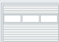
Motiv 480 Lamelová výplň s hliníkovým rámem vyplněným roztahovací mříží Ventilační průřez: 58 % plochy výplně na rám
