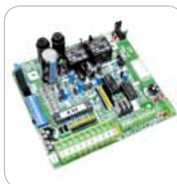
Integrovaná elektronická řídicí jednotka ELPRO 62, vybavená pro instalaci zásuvné desky rádiového přijímače
