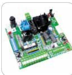
Integrovaná elektronická řídicí jednotka ELPRO 63, vybavená pro instalaci zásuvné desky rádiového přijímače
