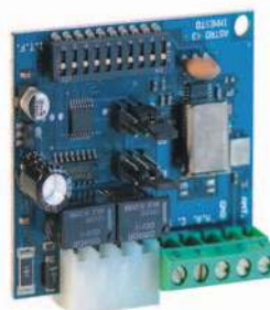
ASTRO 43/2R zásuvný rádiový přijímač
