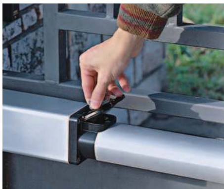
Ruční odblokování pomocí speciálního klíče
